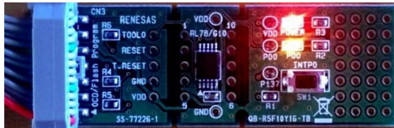
QB-R5F10Y16-TBで動作中のシンプルテンプレート (Tinyテンプレート利用)
